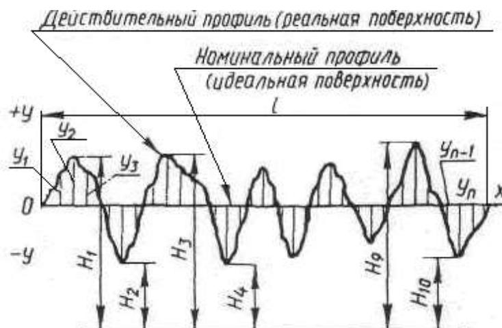
Рисунок 2. 8 – Неровности на базовой длине
