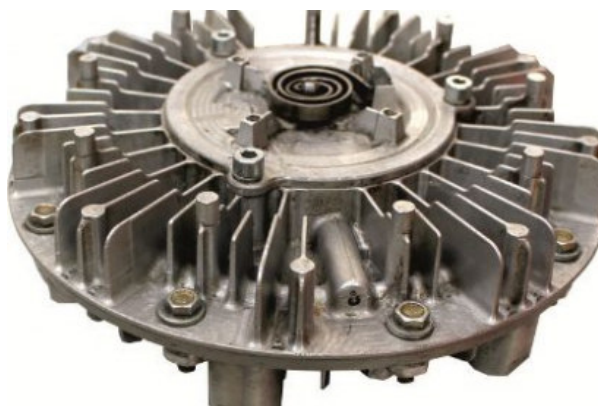
Рисунок 25 - Общий вид вязкостной муфты.
