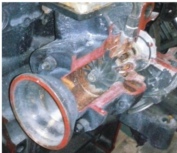
Рисунок 10 – Общий вид нагнетающей полости турбокомпрессора в разрезе.
