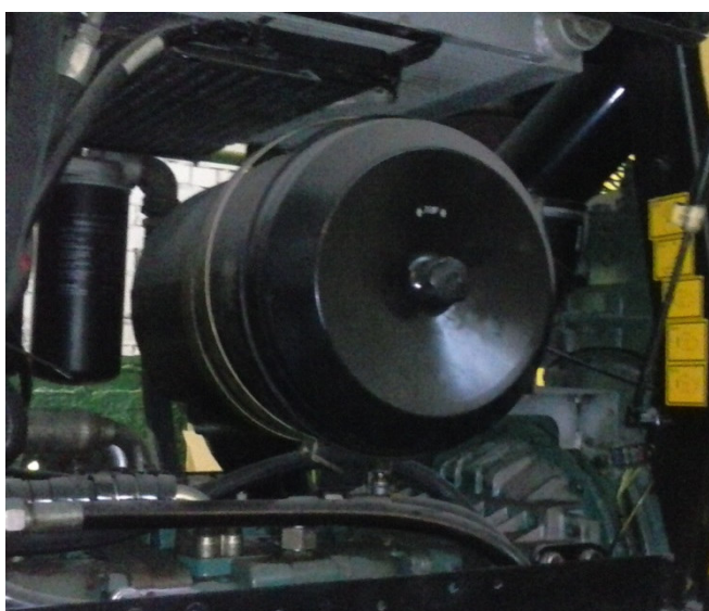
Рисунок 9 – Воздушный фильтр с бумажным фильтроэлементом.
