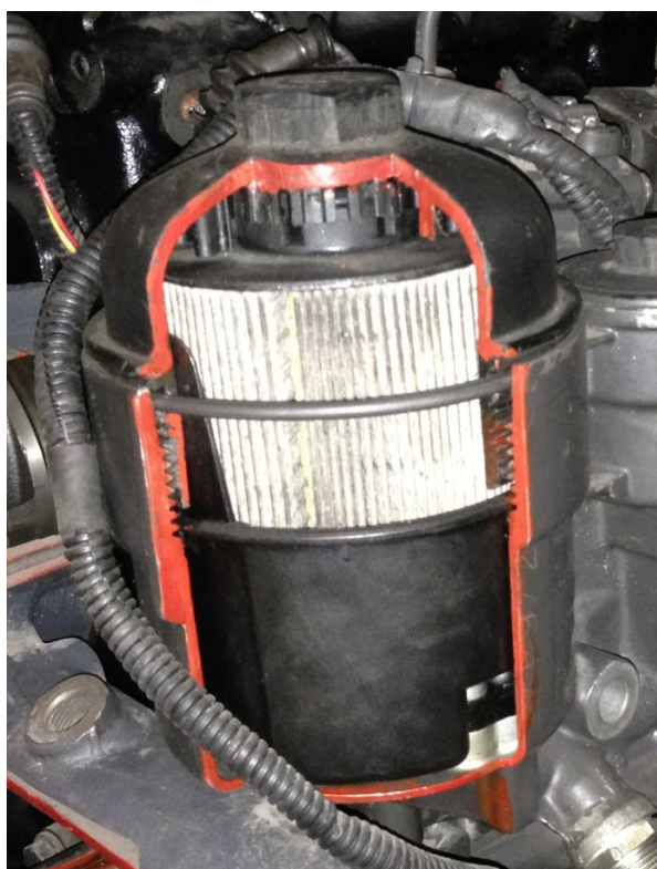
Рисунок 15 – Фильтр тонкой очистки топлива.
