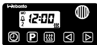
Рисунок 33 - Общий вид пульта управления предпусковым подогревателем.
