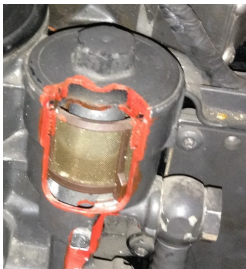
Рисунок 14 – Общий вид сетчатого фильтра предварительной очистки топлива.
