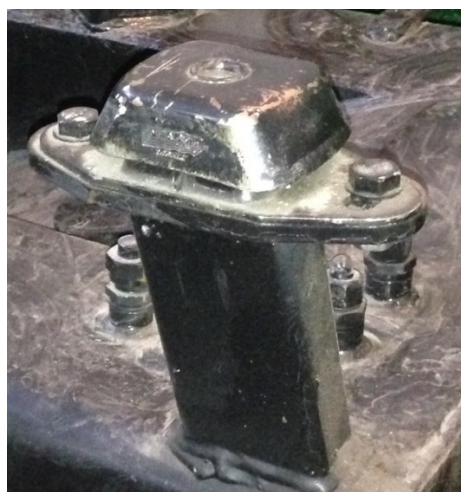
Рисунок 3 – Общий вид эластичного виброизолятора.
