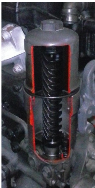
Рисунок 30 – Масляный фильтр со снятым фильтрующим элементом.
