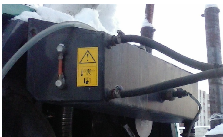
Рисунок 27 – Расширительный бачок системы охлаждения.
