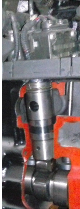
Рисунок 16 – Топливный насос высокого давления.
