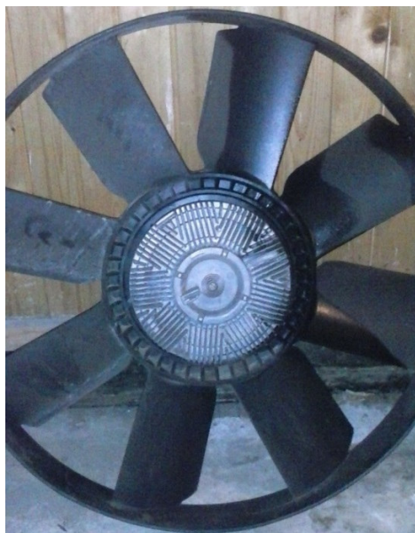
Рисунок 26 - Общий вид вентилятора с вязкостной муфтой.
