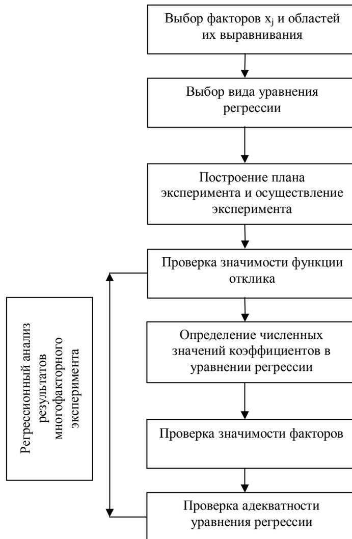
Рисунок 1 – Блок-схема интерполяционной задачи
