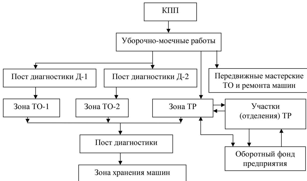
Рисунок 2.2 – Технологическая схема ТО и ТР машин на проектируемом предприятии
